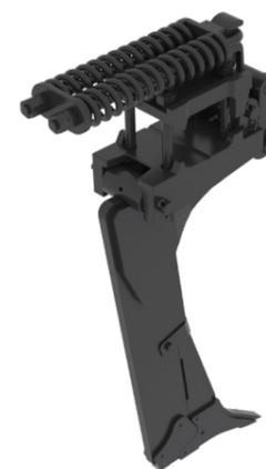
**HASTE ESCARIFICADORA:** Fabricada com materiais de alta resistência e geometria que permitem elevado poder de penetração e descompactação do solo, com o mínimo revolvimento da superfície. Composta por faca superior e ponteira removível com maior ângulo de ataque. Equipada com sistema de desarme automático através de mola helicoidal dupla.
